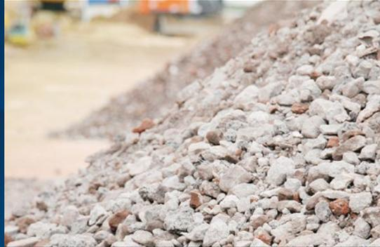
Die Eingangsstoffe für die Produktion von Recyclingbaustoffen in unseren Recyclinganlagen sind mineralische Bauabfälle wie Bauschutt und Straßenaufbruch.
