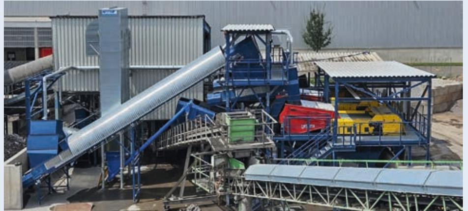
Zusätzliche NE-Abscheider am Feinkorn steigern die Rückgewinnung von NE-Metallen
