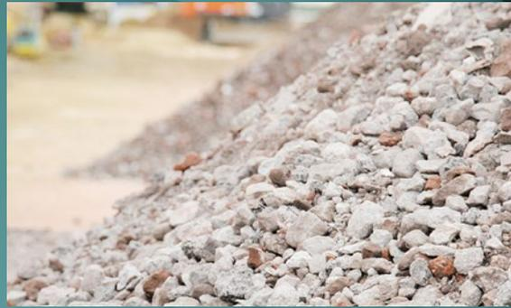
Die Eingangsstoffe für die Produktion von Recyclingbaustoffen in unseren Recyclinganlagen sind mineralische Bauabfälle wie Bauschutt und Straßenaufbruch.
