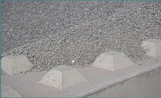
Aus der Rostasche der Müllverbrennung produziert REMEX durch Einsatz neuester Recyclingtechnologien hochwertige Ersatzbaustoffe, die im Baubereich vielseitig einsetzbar sind.
